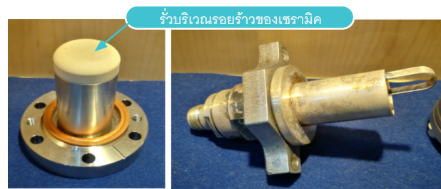
รูปที่ 1 แสดง RF Pickup Probe ที่เกิดการรั่ว
