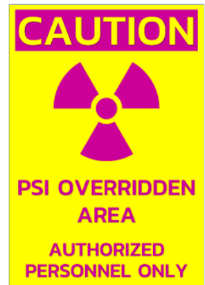
รูปที่ 10 ภาพแสดงป้ายเตือนการปิดระบบ Personnel Safety Interlock (PSI)
