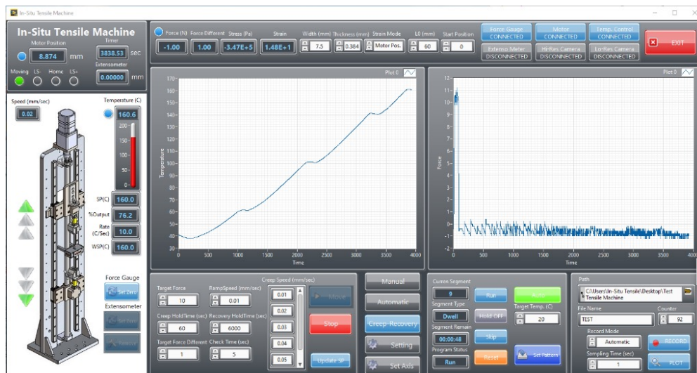
รูปที่ 2 ภาพแสดงฟังก์ชันควบคุมอัตราการดึงขึ้นทดสอบในขณะที่ทดสอบการคืบเมื่ออุณหภูมิไม่คงที่ และอัตราการคืบของขึ้นทดสอบเปลี่ยนไป
