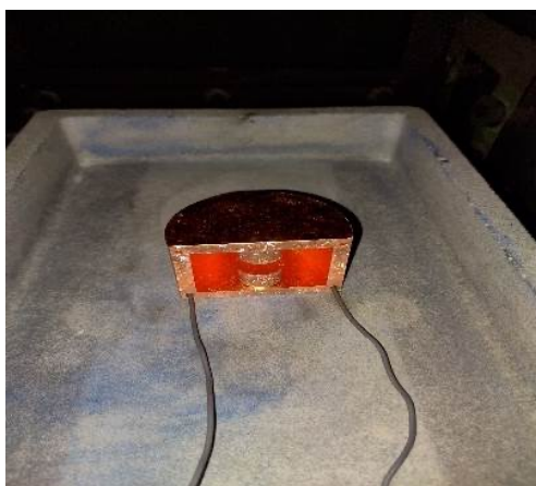
รูปที่ 2 ภาพแสดงชิ้นงาน Side coupling ในกระบวนการเชื่อมต่อประสาน ชิ้นงานในขั้นตอนการเชื่อมต่อประสานจริง (ซ้าย) ชิ้นงานหลังการเชื่อมต่อประสานแล้วเสร็จ (ขวา)
